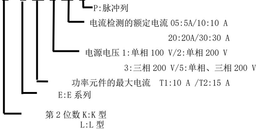
▶电机 (型号):E 系列驱动器对应的电机
