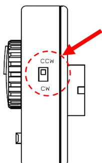
由于本次变更，印刷基板到开关的高度发生了变化（3.5mm→4mm），因此将商品正面（速度旋钮所在面视为正面）面向自己时，
