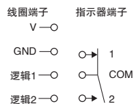
TTL驱动磁保持型 (带自动切断功能)
